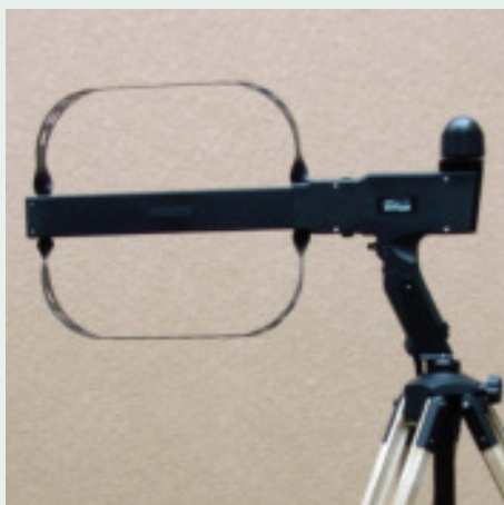
Abbildung 1.6 Messantenne für hochfrequente Felder a) für den Frequenzbereich 20 bis 200 MHz
