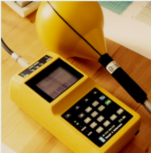
Abbildung 1.5 Messgerät für niederfrequente Felder mit einer isotropen Messsonde, die gleichzeitige Messungen magnetischer Felder aller Richtungen erlaubt
